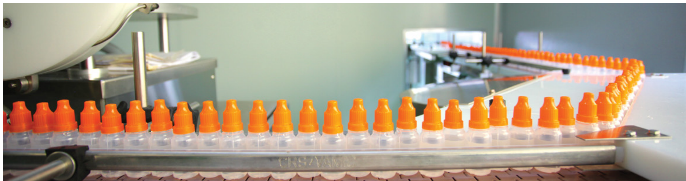
Dây chuyền sản xuất thuốc nhỏ mắt của Traphaco theo công nghệ BFS - hiện đại nhất hiện nay.
